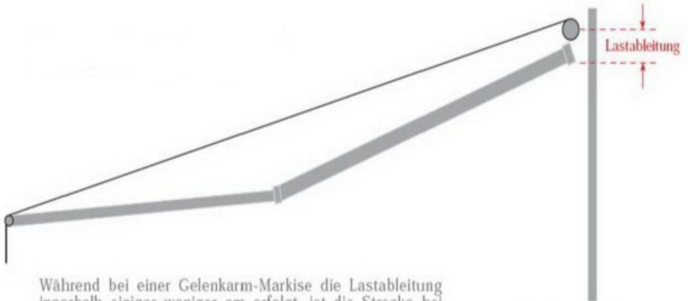
Während bei einer Gelenkarm-Markise die Lastableitung innerhalb einiger weniger cm erfolgt, ist die Strecke bei einer CASSANI-Scherenarm-Markise wesentlich größer. Es können also wesentlich größere Windlasten aufgenommen werden; **je nach Montage-Untergrund und je nach Armanzahl bis zu Windstärke 9 Beaufort = 80 km/h**. Die Windstabilität muss von uns jeweils schriftlich uneingeschränkt zugesagt sein, um als zugesicherte Eigenschaft zu gelten.
